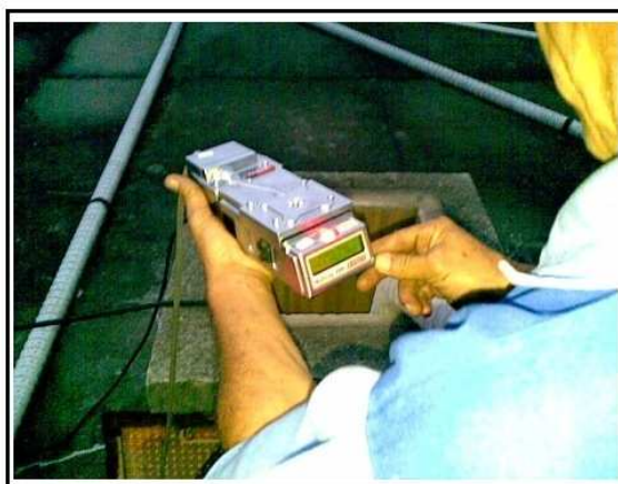
Figura 23 – Medição dos gases presentes na atmosfera. Fonte: Fotos do autor.
